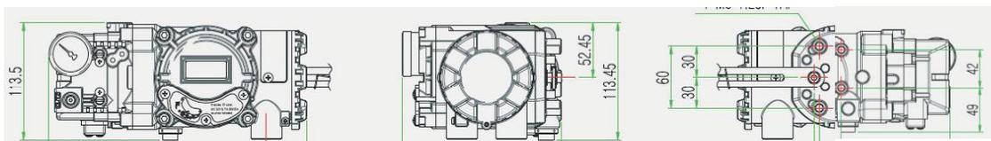
В позиционере УТ-2400 электронная и пневматическая часть находятся в разных корпусах, что полностью исключает влияние влажного воздуха на работу электроники.
